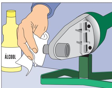
**1-** Cuando se comienza a trabajar o cada vez que haga falta, limpiar las boquillas del termofusor con un trapo embebido en alcohol y verificar su correcto ajuste sobre la plancha de aluminio.
