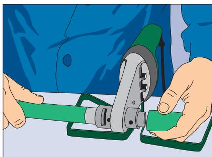
**2 -** Después de cumplida la etapa de calentamiento, esto es 5 segundos para los tubos de 20 mm y 7 segundos para los tubos de 25 mm, unir rápidamente tubo y accesorio observando que los dos cordones de fusión hagan tope (ver proceso de termofusión en las páginas 14 y 15 y tiempos de calentamiento en tabla 1 de la página 18)
