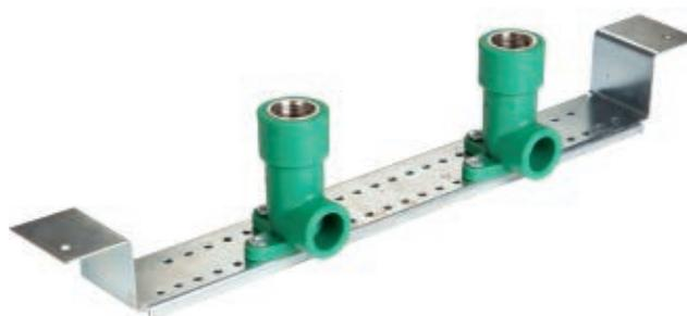
La posición y fijación definitiva se conseguirá, haciendo coincidir los extremos libres de los accesorios con las perforaciones realizadas en el panel. Estas perforaciones se harán a la distancia que corresponda según el artefacto sanitario a conectar (**fig. c**).
