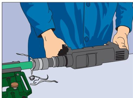
**1-** En forma simultánea introducir tubo y accesorio en sus respectivas boquillas y hacerlo en forma perpendicular a la plancha (ver tabla 2 en página 18 de este manual)
