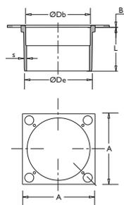
**Boca de acceso horizontal c/salida 110mm y 3 entradas de 63mm**
