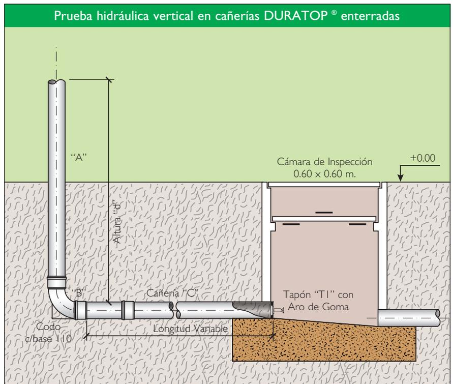
En realidad, en cañerías enterradas, la presión de prueba depende de la carga real que va a actuar sobre la cañería en funcionamiento, trabajando a sección llena.
