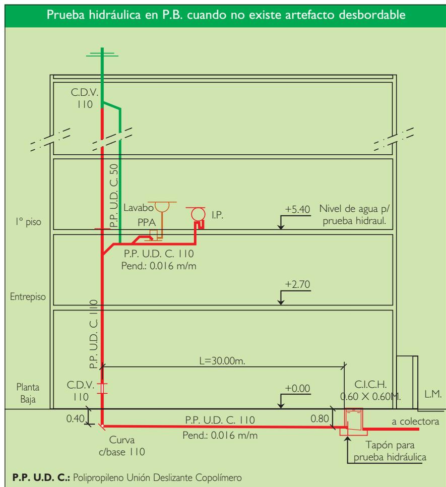
de la mañana cuando la cañería no se encuentra dilatada por efecto de la acción solar. Para evitar errores de lectura, es conveniente, a medida que se va llenando de agua, desalojar el aire que puede estar contenido dentro del caño. Por supuesto, antes de la prueba se debe verificar el calce y sostén de toda la tubería, la cual, debe estar ubicada correctamente en su posición altimétrica definitiva.
