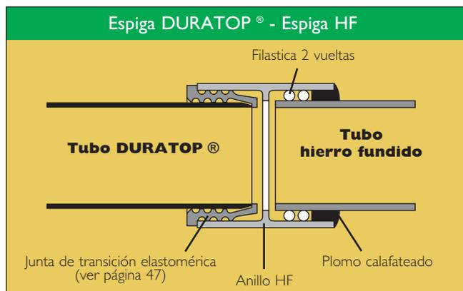
NOTA: El ejemplo de unión entre espigas de tubos DURATOP® y tubos de hierro fundido es válido también para empalmar con los diferentes embudos de hierro fundido que se comercializan en el mercado.
